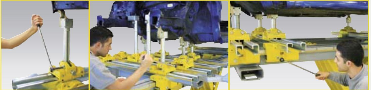
Sistema di tiro in alto, in basso e spostamento traverse, mediante sistema ad ingranaggio e cremagliera. / *Upward and downward pulling system and possibility to move the cross members with rack and pinion system.*
